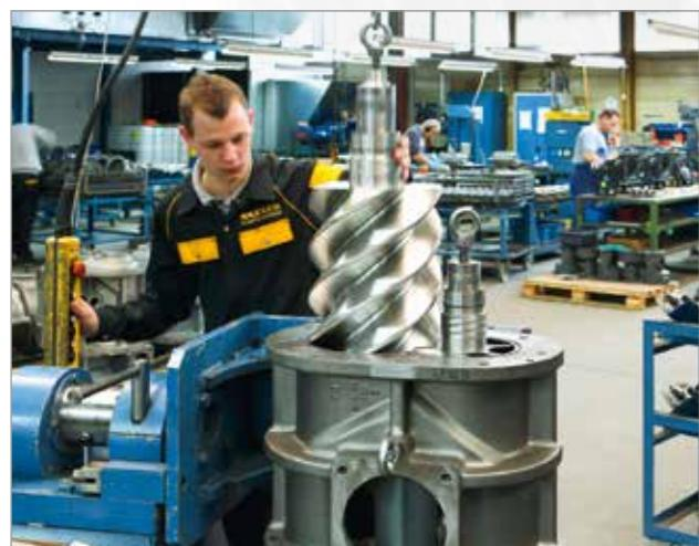
optimalnim brojevima okretaja postiže visoka energetska učinkovitost. Veliki, prilagođeni i precizni valjkasti ležajevi i izrada s minimalnim tolerancijama jamče dugi vijek trajanja i veliku pouzdanost.
